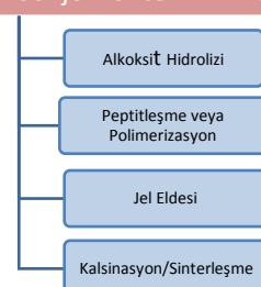
**Şekil 2:** Sol-gel Yönteminin Basamakları
