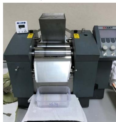
Şekil 1. Kalender (three roll mill) cihazı.
