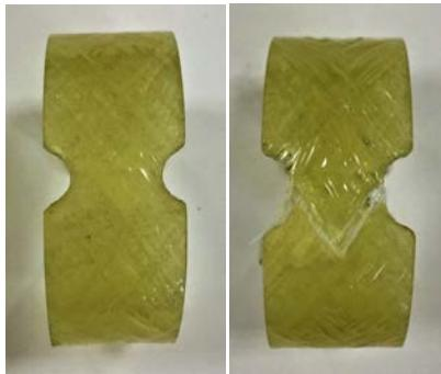
Figür 3: Test Öncesi ve Sonrası Numune Görüntüleri
