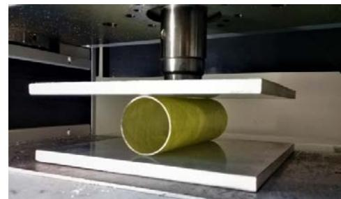
Figür 2: Radyal Basma Testi Kurulumu
