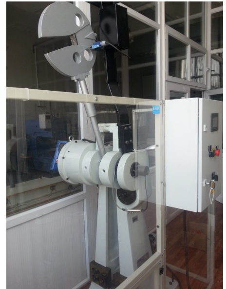
Şekil 9. Charpy çentik-darbe deney düzeneği.
