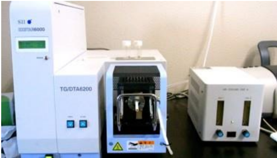
Termal Gravimetrik Analiz/ Diferansiyel Termal Analiz (TGA/DTA) (Seiko Exstar TG/DTA 6200)
