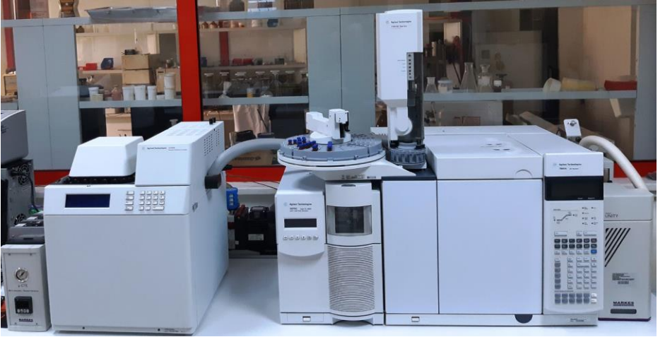
Gaz Kromatografisi-Kütle Spektrometresi (GC-MS) (Agilent 7890A Gaz Kromatografisi 5975C Kütle Spektrometresi )
