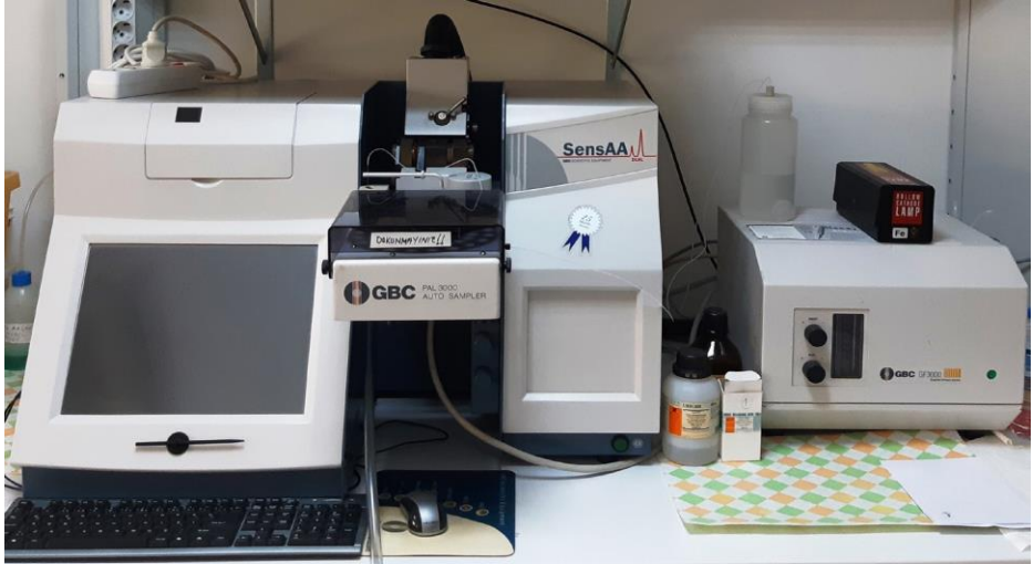
Grafit Fırınlı Atomik Absorpsiyon Spektrofotometresi (GFAAS) (GBC)
