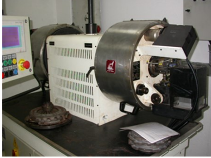
Şekil 8: Devir altında aksenal yorma test makinası
